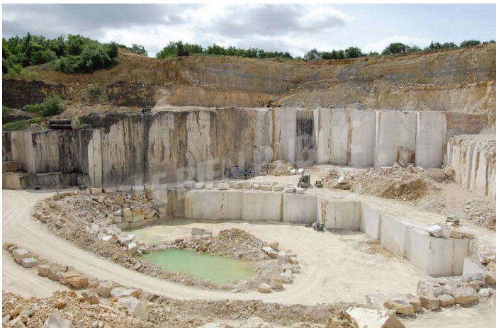
Doc. 3 : Une carrière de calcaire : mélangé avec des argiles, le calcaire permet la production de ciment, indispensable à la construction.
